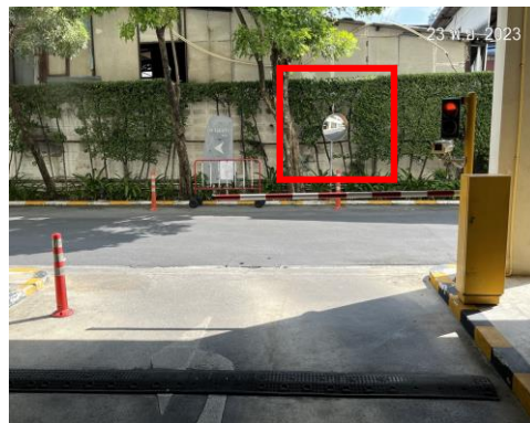
รูปที่ 2-24 การติดตั้งกระจกโค้งจราจร
